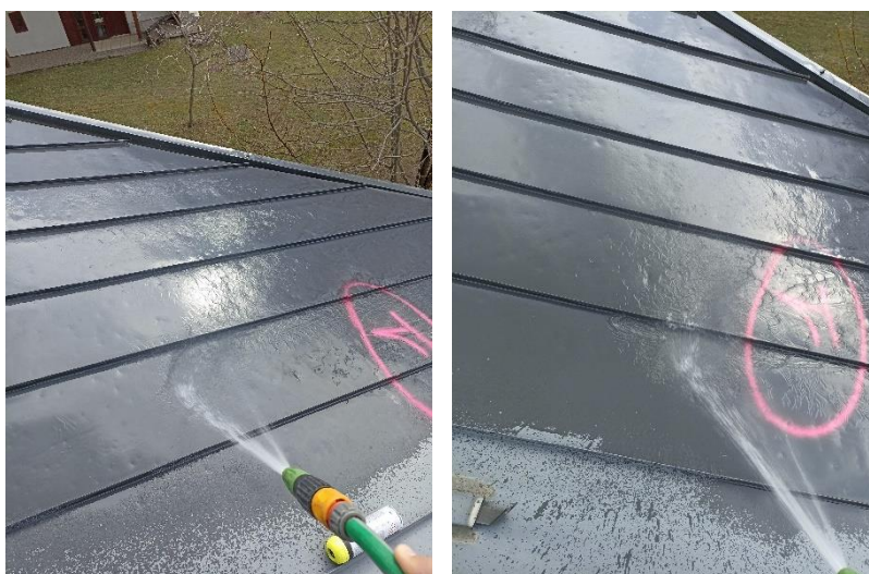
Aspersions soutenues sur les pliages de recouvrement.
