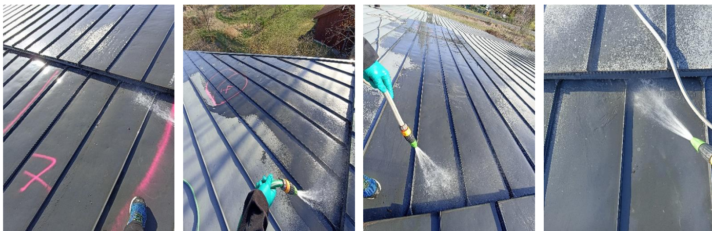
Aspersions sur les recouvrements toiture dans l'axe des zones 4, 5, 6 et 7
